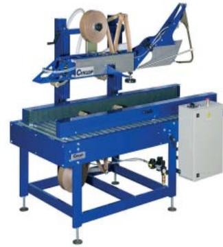
Modelo que incorpora un dispositivo automático para obtener el doblado de las solapas superiores de las cajas previo al sellado con el papel engomado definido. La inclusión de este dispositivo permite la posibilidad de integrar la máquina en una línea de embalaje automatizada.
