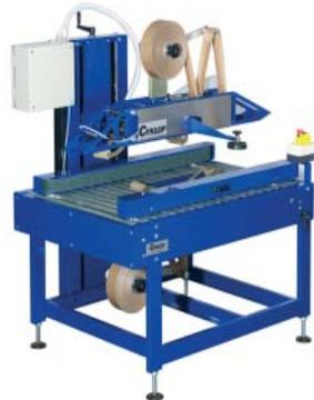
Las cajas son introducidas manualmente en la máquina con las solapas superiores ya cerradas previamente por el operario
